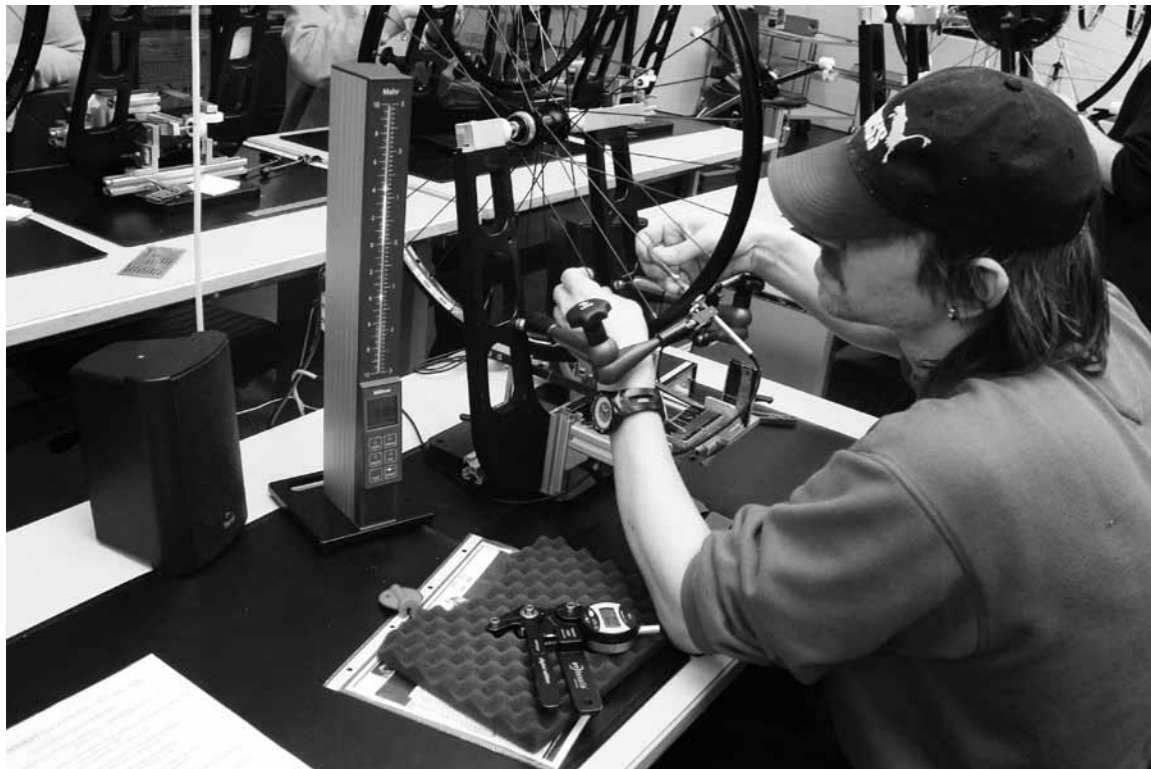
Akustische Zentriervorrichtung für die Einspeichung von Laufrädern
